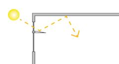
**SVJETLOSNA POLICA** je element koji se dodaje na prozor kako bi se preusmjerio odsjaj dnevnog svjetla ka plafonu i smanjio nivo dnevne svjetlosti uz prozor. To se uglavnom primjenjuje na fasade i lokacije koje izložene direktnoj sunčevoj svjetlosti.
